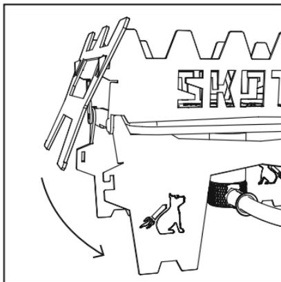
**6.** Klappe nun das Seitenteil (3) nach unten, bis es komplett auf dem äußeren Haken der Boostereinheit liegt. Bringe das zweite Seitenteil (3) auf der gegenüberliegenden Seite der Boostereinheit genauso an.
