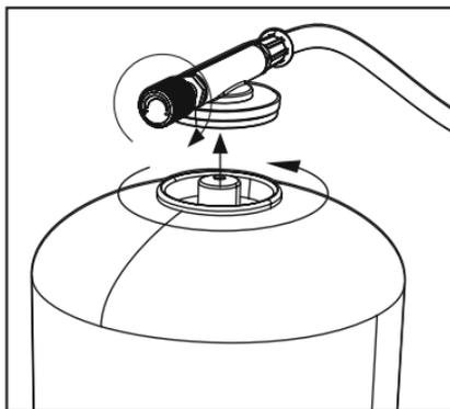
1. Verschließe den Gashahn mit einem handfesten Zudrehen nach rechts (↻), bevor Du die Gaskartusche anschließt.
