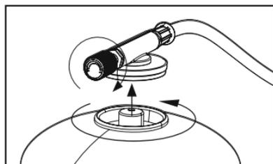
1. Verschließe den Gashahn mit einem handfesten Zudrehen nach rechts (↻), bevor Du die Gaskartusche löst.
