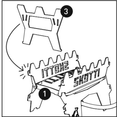
**4.** Fahre fort mit einem der beiden Seitenteile (3), welches zunächst von oben auf die dafür vorgesehenen äußeren Haken an den Auflageflächen an der Boostereinheit (1) eingehakt wird.
