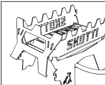
**5.** Um mehr Auflagefläche zu haben, verwende die äußeren Schlitzte der Seitenteile bei der Montage. Bei kleineren Gefäßen kannst du die inneren Schlitzte verwenden.
