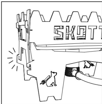
**7.** Klappe nun die Standfüße erst leicht nach außen, damit du diese auf die dafür vorgesehenen Haken der Seitenteile (3) schieben kannst. Drücke dann die Standfüße wieder nach innen um die Seitenteile (3) zu arretieren.
