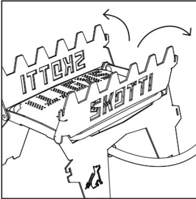
**3.** Danach klappst Du auch die beiden oben montierten Auflageflächen nach links und rechts auf.
