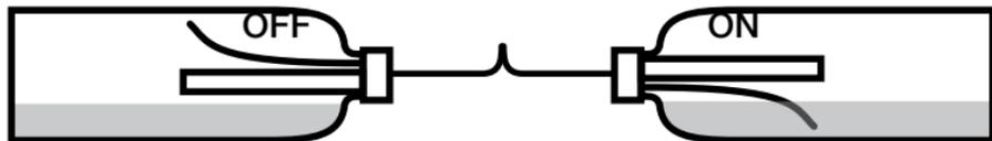
la pompe, vu du dessus. Le combustible se trouvant dans le tuyau se consume jusqu'à la fin et la pression restant dans le réservoir s'échappe. La flamme ne s'éteint pas immédiatement, mais brûle encore quelques minutes, selon le combustible utilisé et le degré d'ouverture du robinet d'alimentation.
