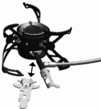
Tous les combustibles contiennent des impuretés qui peuvent obstruer le gicleur du brûleur. Optimus Nova intègre une aiguille de nettoyage intégrée qui vous permet de nettoyer facilement le gicleur. Faites aller et venir l'outil multi-usages plusieurs fois juste en dessous de l'écrou de fond du brûleur. Les aimants de l'outil font bouger l'aiguille de nettoyage, ce qui nettoie le gicleur.
